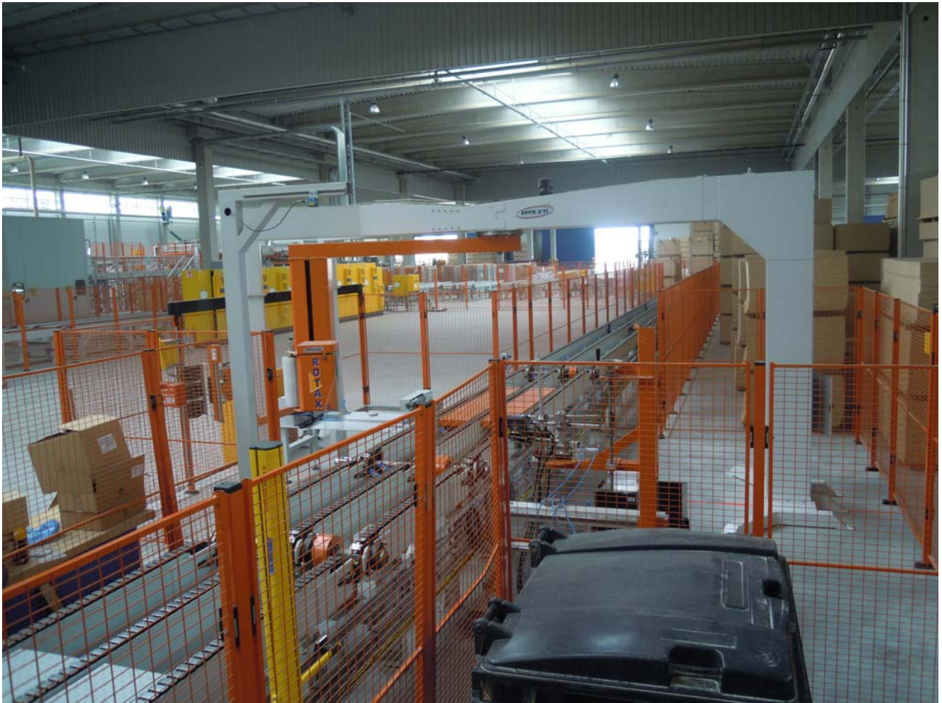
die beiden Dreharmwickler stehen am Ende der jeweiligen Transportlinie, unmittelbar nach den Umreifungsmaschinen
