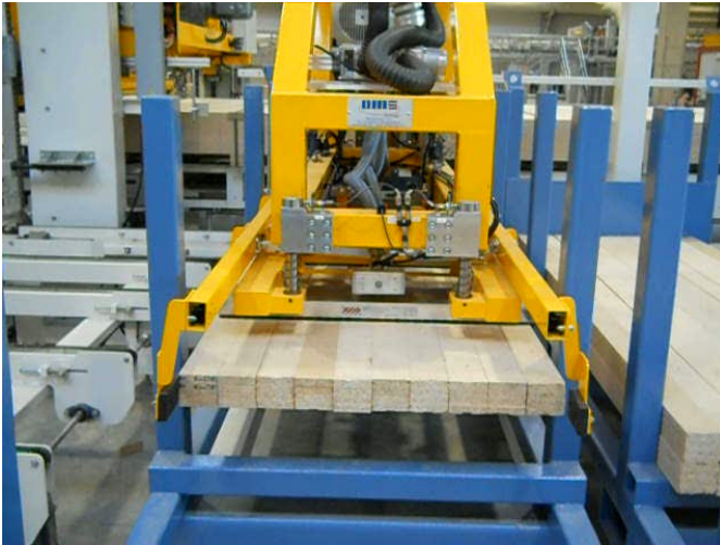
Lagengreifer entnimmt eine Lage Kanthölzer aus den Transportboxen
