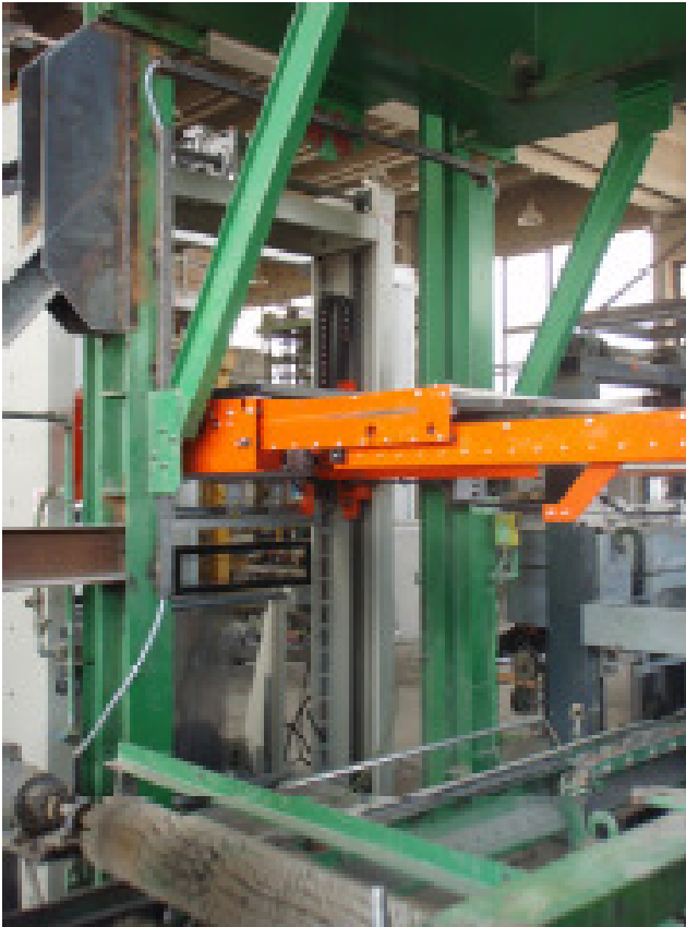
Netzaufleger eingebaut in Palettierer
