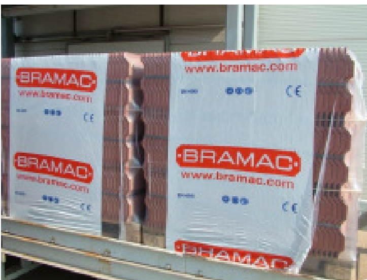
Der Haubenschrumper ersetzt eine Wickelmaschine. Das Paket besteht aus bereits umreiften Betondachsteinpakete.
