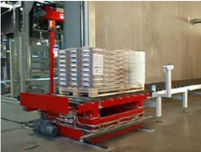
Verfahrwagen bringt das Produkt zur Abnahmestrecke
